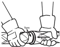
Para la tubería de 3 a 6 pulgadas de diámetro, el dar vuelta no es práctico, así que alinee la tubería y empuje hasta que las superficies sea en contacto. Una fuerza impulsora se debe utilizar para asegurar las juntas. La fuerza adicional puede ser proporcionada usando un pedazo de la madera dura y de un martillo.
