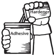
Continúe mezclándose hasta que se obtiene una mezcla uniforme y todo el pegamento se mezcla adentro de los lados y de las esquinas de la lata. Una consistencia uniforme lisa indica mezclarse adecuado del pegamento
